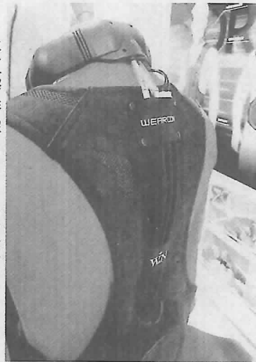
水冷式で排熱するクラレの冷暖房ジャケット
